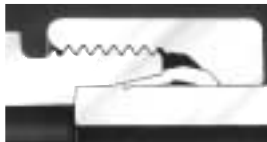
Cutting ring - Deformation from excessive tightening Schneidring - Deformation bei Überanzug Bague coupante - Déformation par serrage excessif
